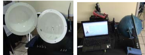
Figura 6. Prototipo para la medición del flujo luminoso, modelo final.
