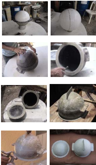
Figura 3. Etapas en la construcción del cuerpo de la esfera.
